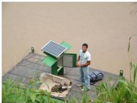
FOTO 1: Instalação a montante: flutuante que recebeu a sonda multiparâmetros para o monitoramento em tempo real
