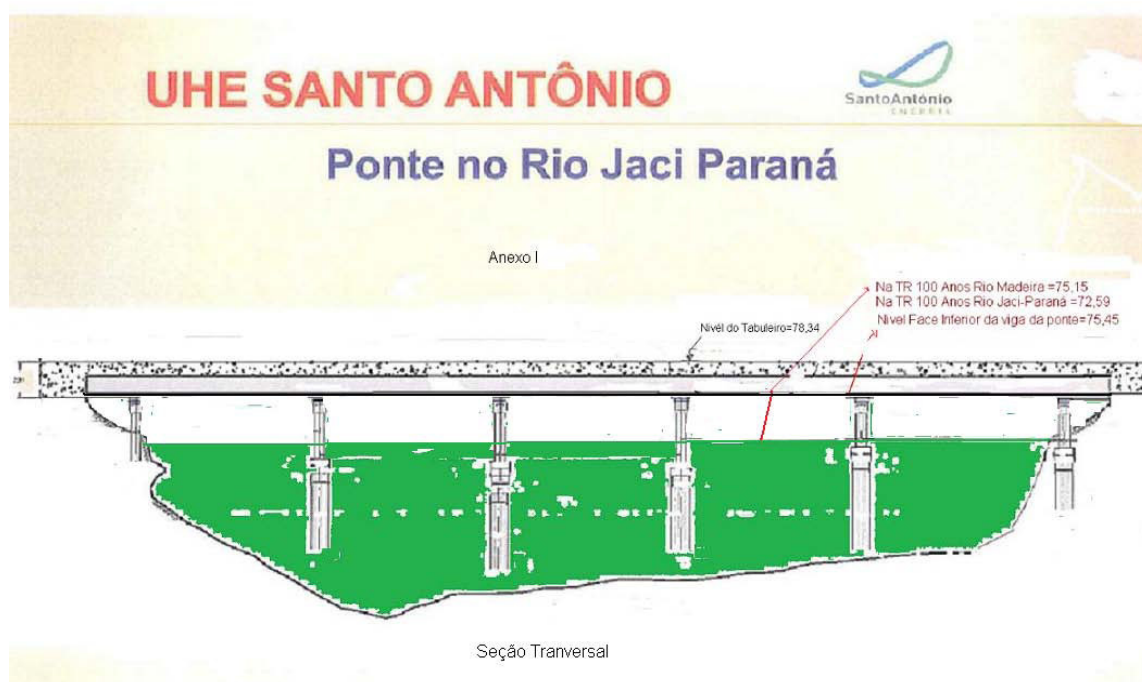
Figura 47 - Seção transversal na ponte do rio Jaci Paraná.
