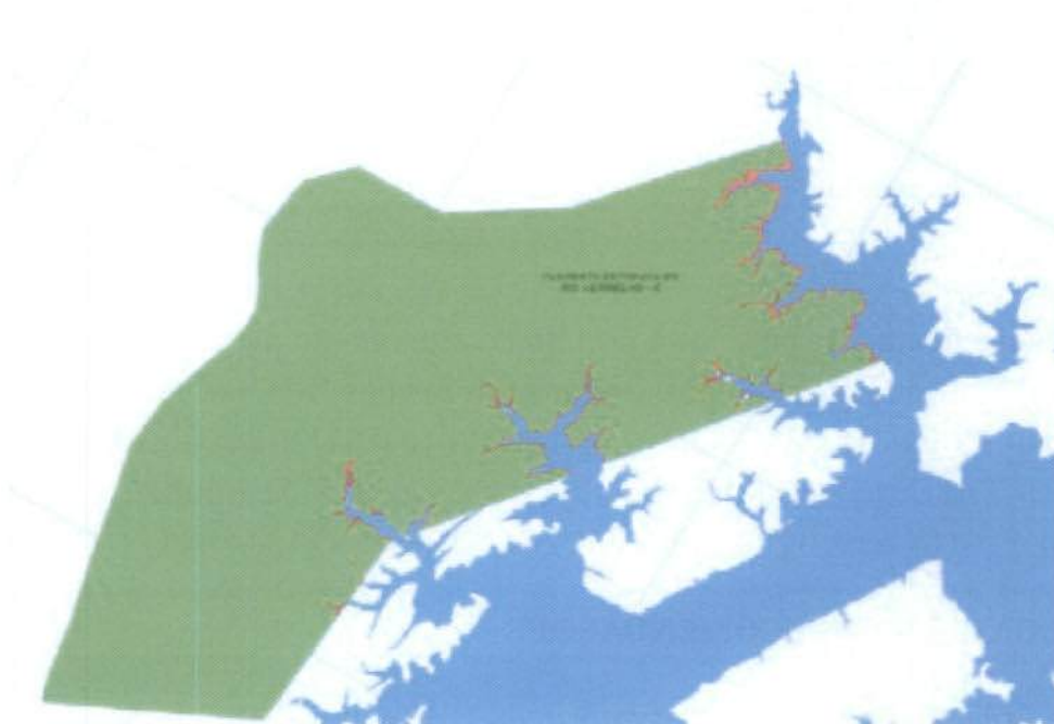
Figura 08 - Áreas previstas de afetação (em vermelho) na Floresta Estadual de Rendimento Sustentado Rio Vermelho C (40,59 ha) pelo reservatório na cota 71,3m e 36.200 m 3 /s (PBCA).
