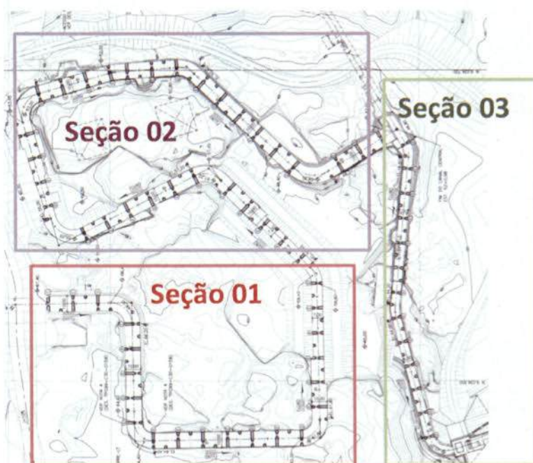
Imagem 3: Seccionamento do canal de transposição de peixes da UHE Santo Antônio por etapa de resgate
