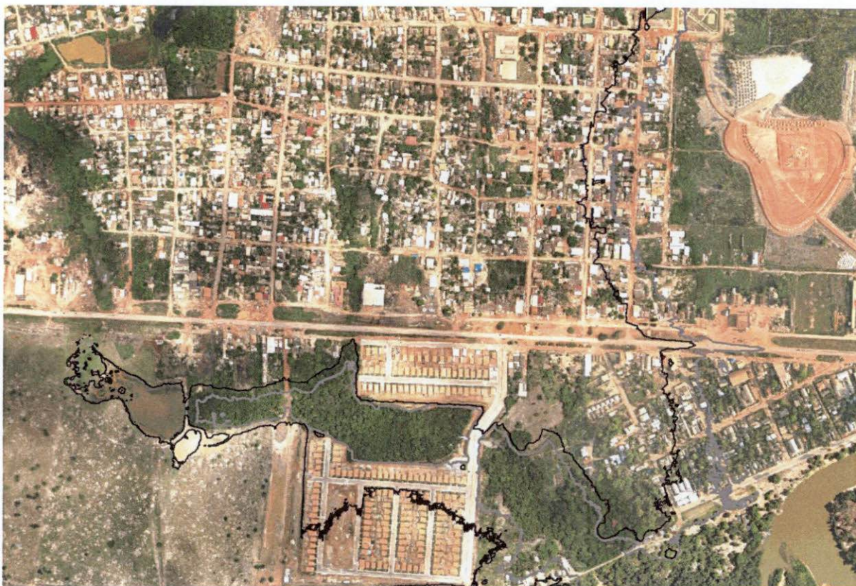
Figura 8. Foto aérea do povoado de Jaci-Paraná, indicando a cota 75,80m (em cinza), abaixo da qual as residências já foram removidas (segundo a SAE), e a cota 77,42m (em preto), correspondente à cheia de 50 anos
