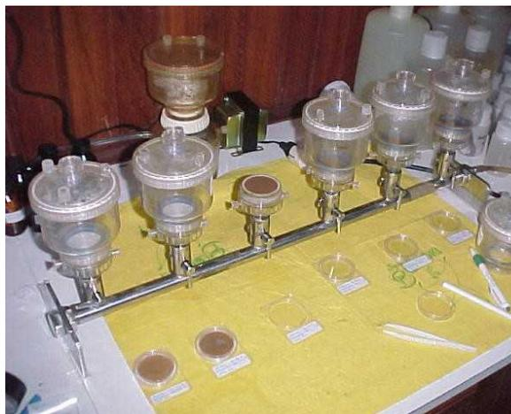
**Figura 7.7 - Dispositivo de filtração frontal Sartorius**
