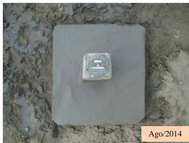
Figura 3.27 Situação dos Novos Marcos de Referência no Local de Monitoramento 6
