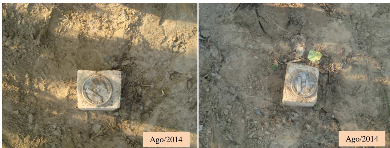
Figura 3.32 Situação dos Novos Marcos de Referência no Local de Monitoramento 7
