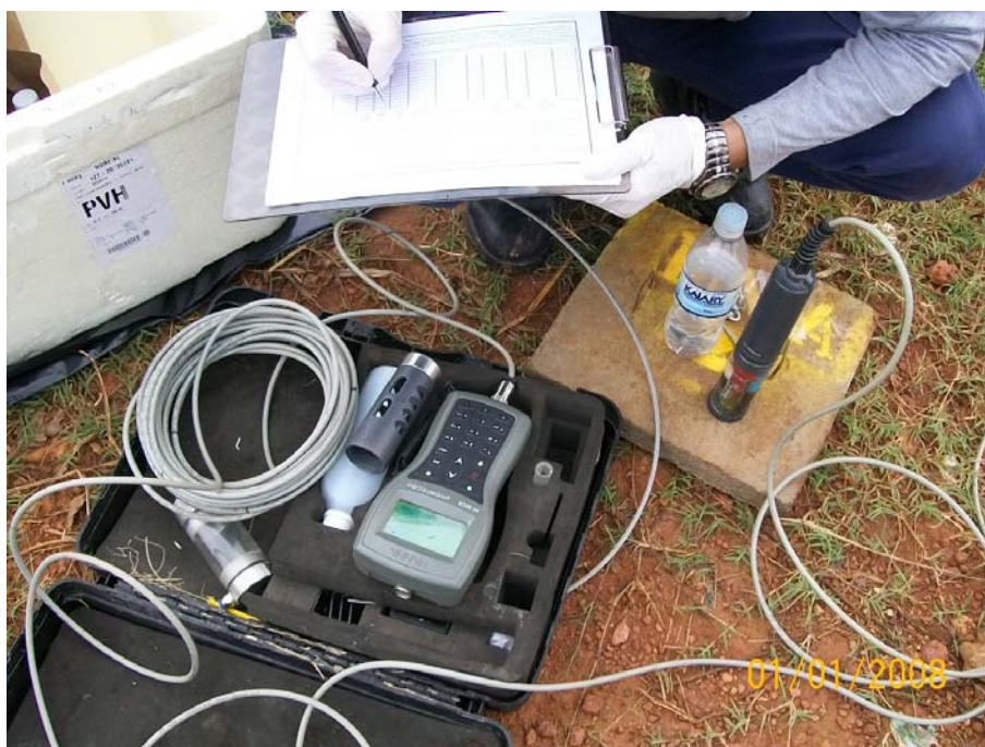
Foto 02 - Medição in-situ de parâmetros físico-químicos, Porto Velho, RO.
