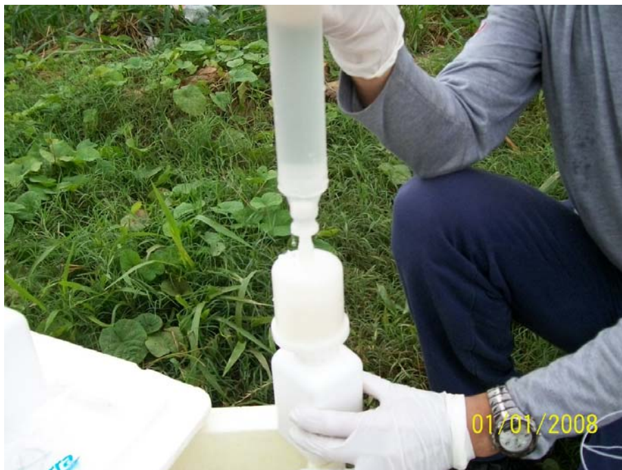
Foto 03 – Utilização de filtro para amostragem de metais dissolvidos, Porto Velho, RO.
