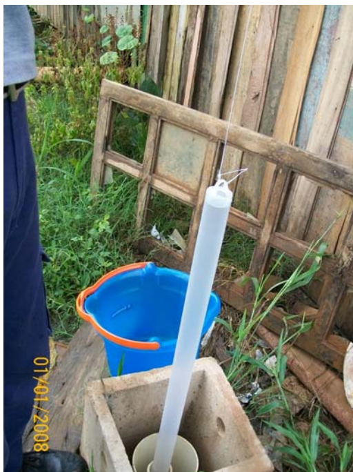
Foto 01 - Coleta de água com bailer no poço MNA-02, Porto Velho, RO.
