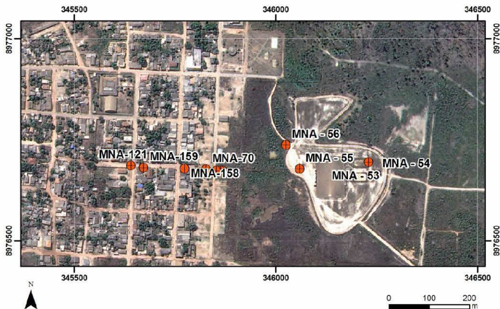
Figura 23 – Distribuição da linha piezométrica instalada para este estudo.
