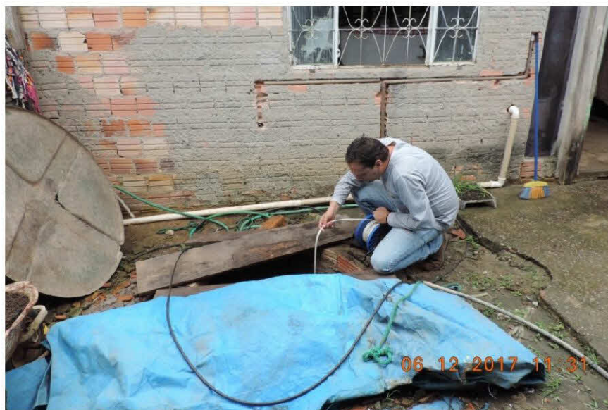
Figura 11 – Medição de nível d'água sendo realizada em cacimba cadastrada no distrito de Jacy-Paraná.
