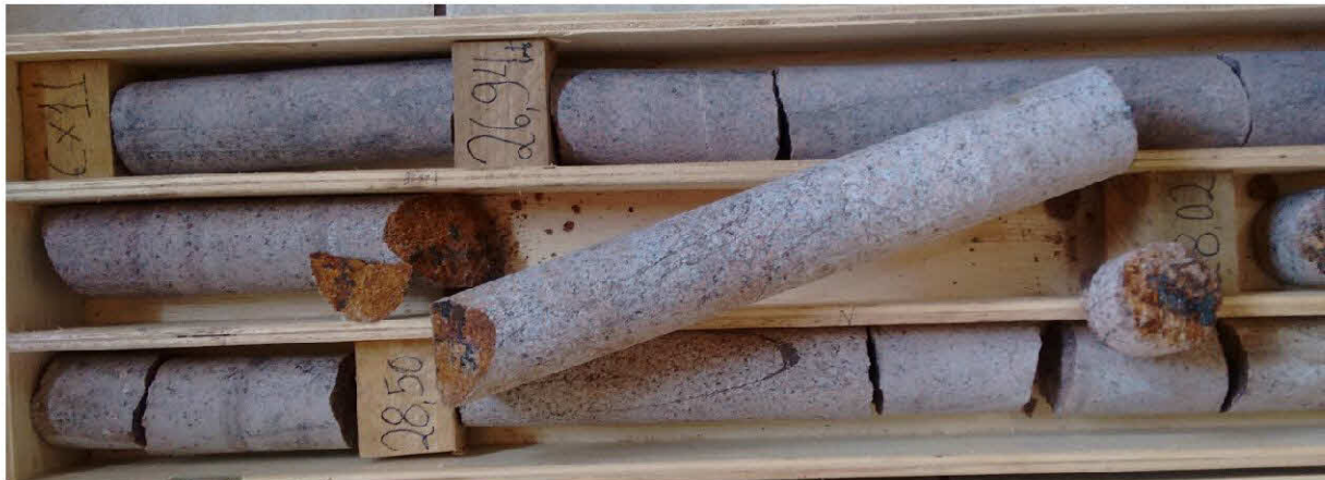
Figura 41 – Testemunho da sondagem entre 27,57 m e 28,18 m com evidências de passagem de água (alteração de parede e deposição de óxidos).
