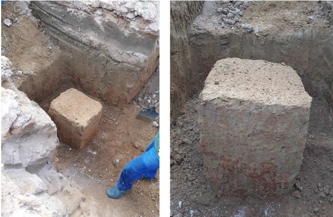
Figura 30 – Processo de coleta de amostra indeformada no distrito de Jacy-Paraná.
