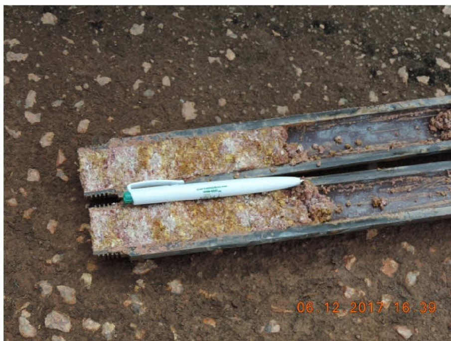
Figura 21 – Material oriundo da perfuração coletado durante realização de sondagem no distrito de Jacy-Paraná.
