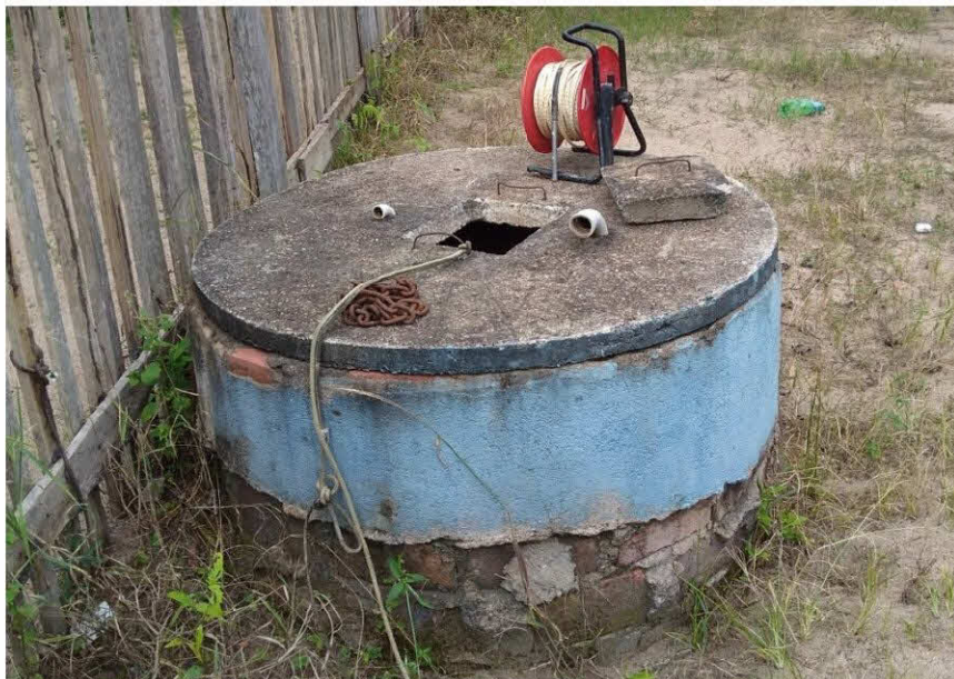
Figura 10 – Medição de nível d'água sendo realizada em cacimba cadastrada no distrito de Jacy-Paraná.
