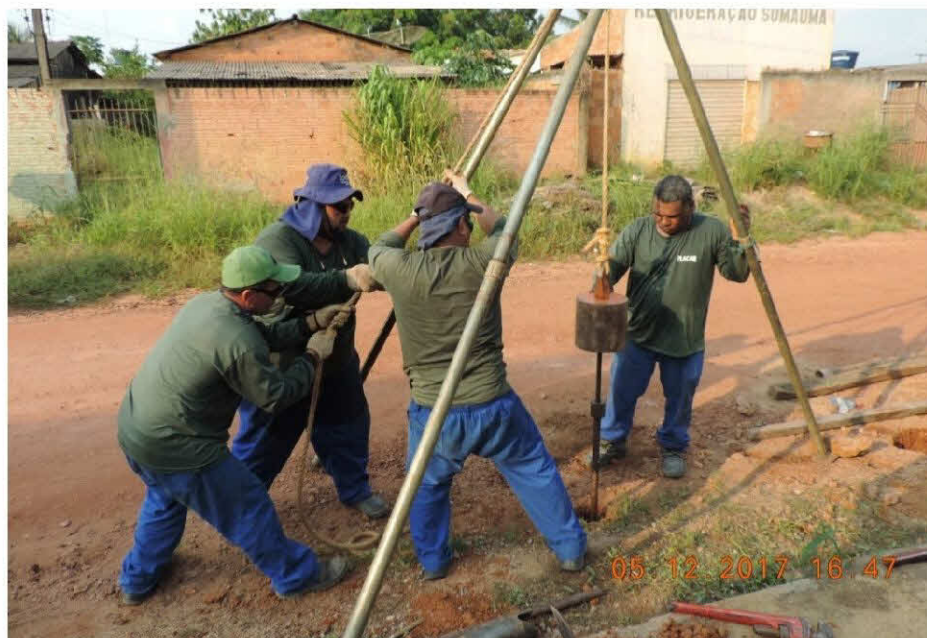
Figura 20 – Execução de ensaio SPT durante sondagem no distrito de Jacy-Paraná.
