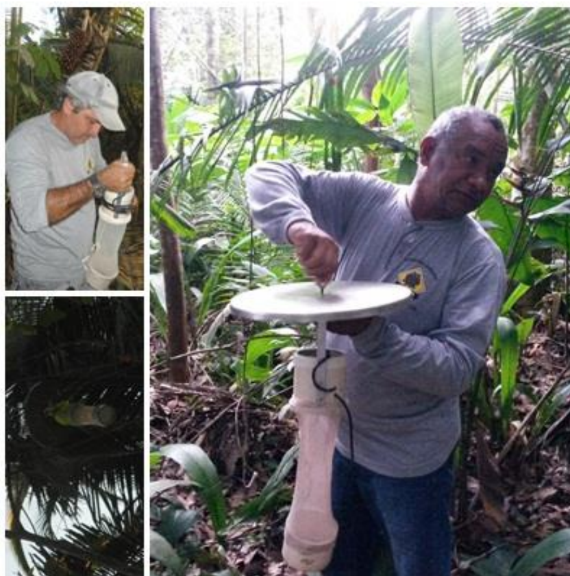
Figura 2. Instalação da armadilha luminosa CDC miniature light trap para a captura de flebotomíneos durante a décima quinta campanha (setembro e outubro de 2015) nas áreas de influência da UHE Santo Antônio, Porto Velho – RO.
