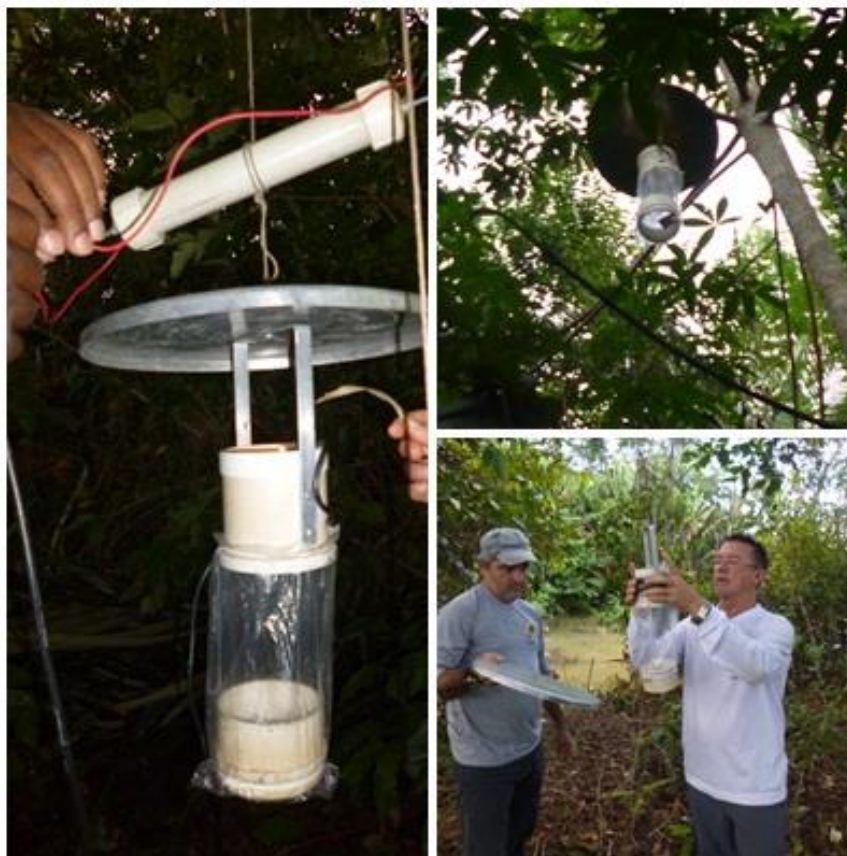
Figura 1. Instalação da armadilha luminosa CDC miniature light trap para a captura de flebotomíneos durante a décima terceira campanha (janeiro/março de 2015) nas áreas de influência da UHE Santo Antônio, Porto Velho – RO.
