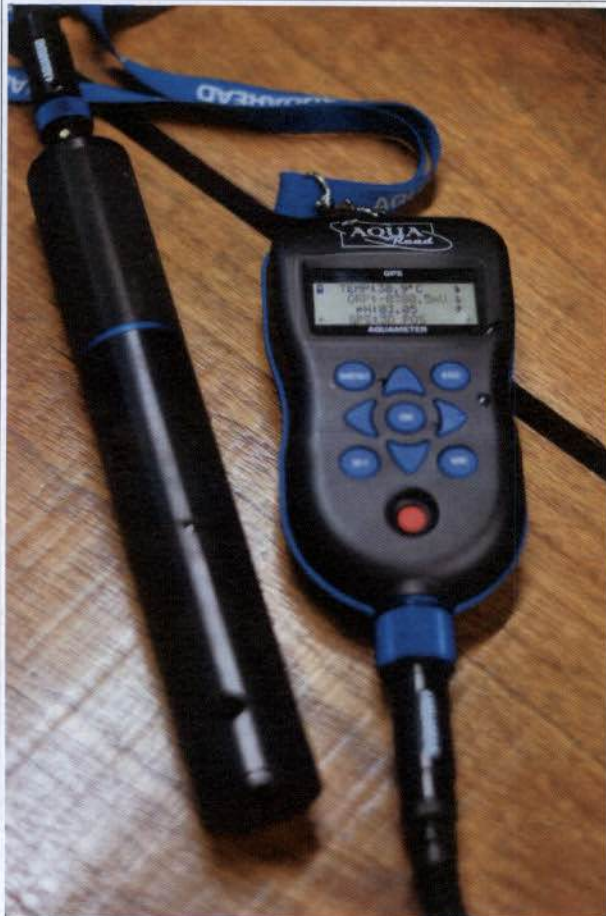
Foto 18: Sonda multiparâmetros utilizada nas medições de parâmetros físico-químicos da qualidade da água.
