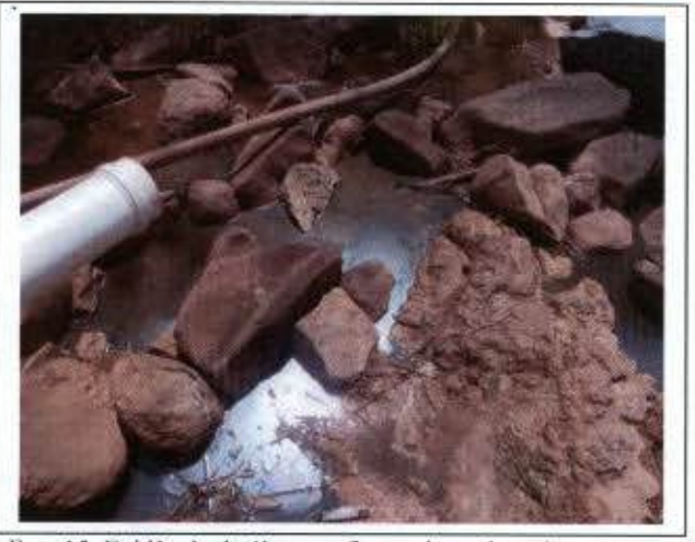
Foto 15: Evidência de óleo no efluente lançado após tratamento pela caixa separadora de água e óleo (rampa de lavagem do canteiro principal).
