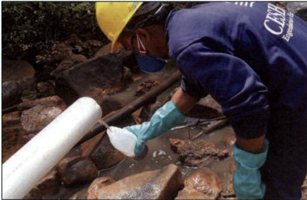
Imagem 05 – Coleta de amostras da saída da caixa separadora de óleo
