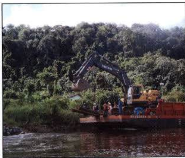
Figura 01 – Equipamento sendo transportado para a margem esquerda via balsa flutuante
