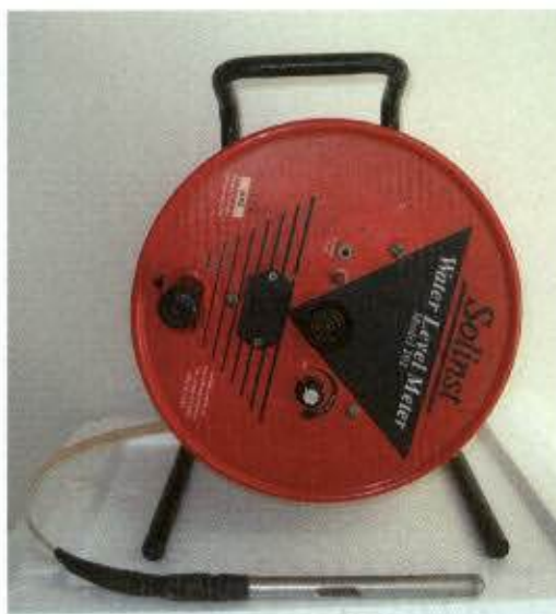
Figura 4 - Medidor manual de nível de água subterrânea.
