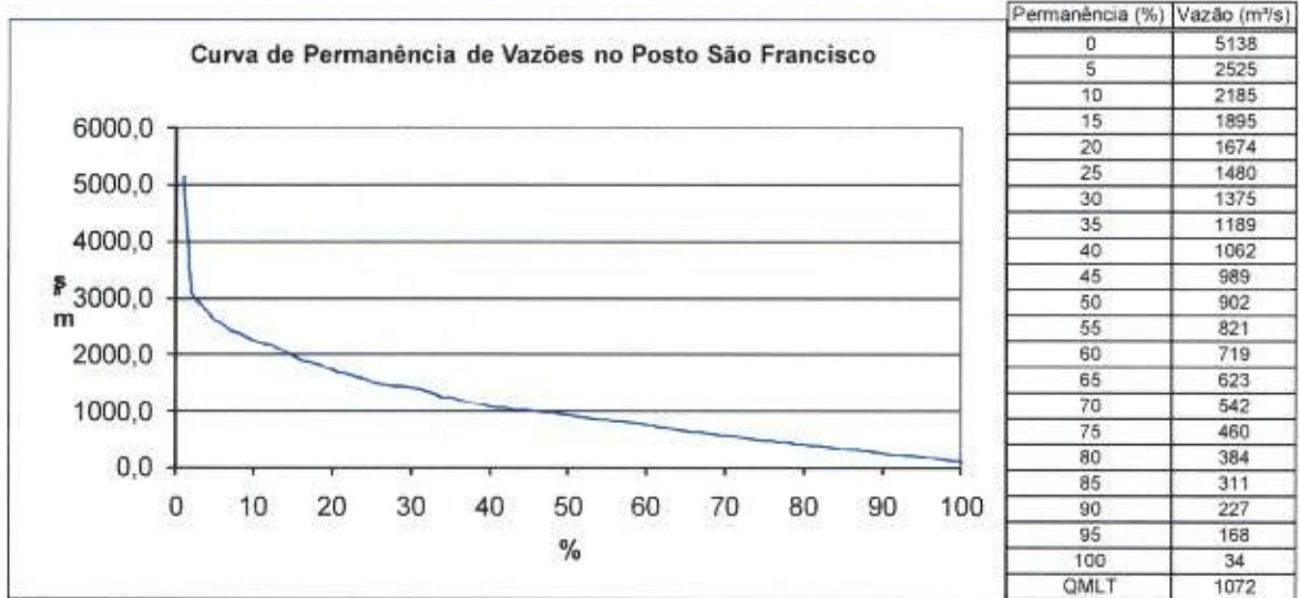
Figura 5.1 - Curvas de Permanência das Vazões (1931 a 2008).
