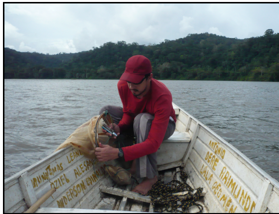
Figura 8.3.3-77 - Rede cônico-cilíndrica com fluxômetro acoplado a boca da rede para obtenção do volume de água filtrada.
