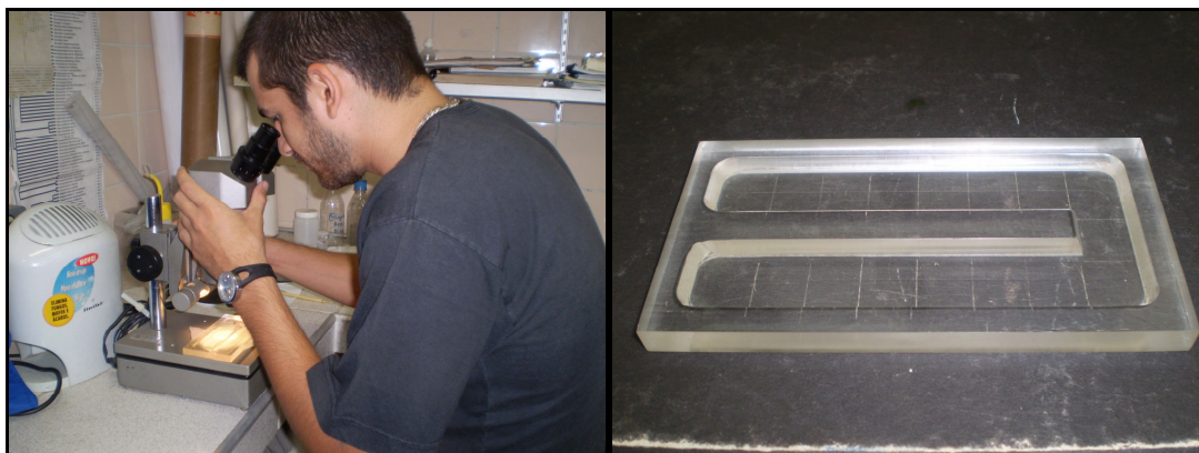
Figura 8.3.3-78 - Triagem das amostras sob microscópio-estereoscópio e placa do tipo Bogorov utilizada para triagem de ovos e larvas de peixes.
