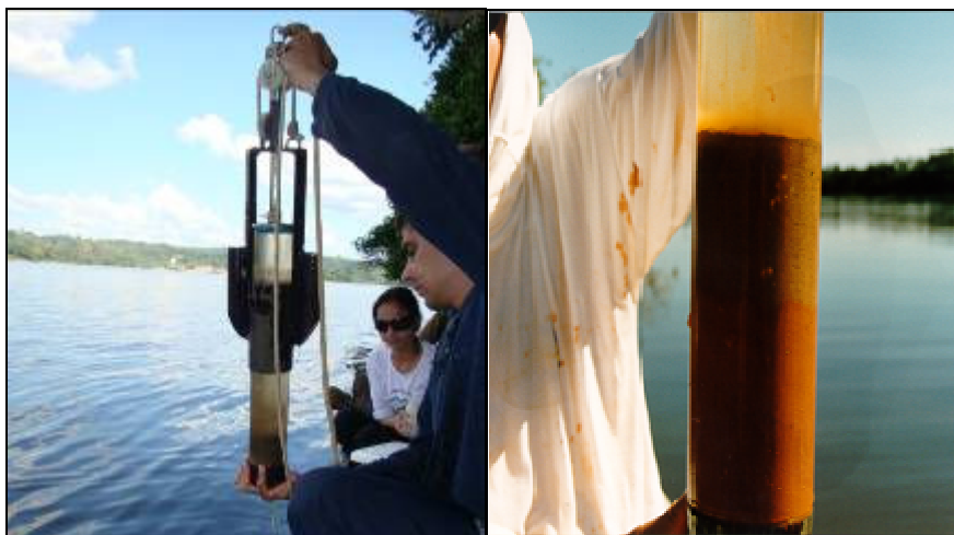
Figura 8.3.2-3 - Coleta de amostra de invertebrados bentônicos, core com sedimento.
