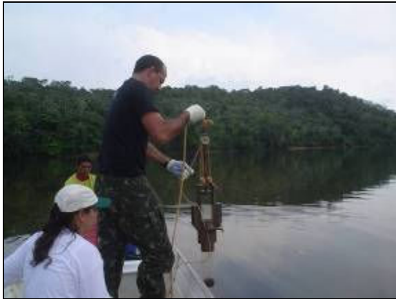
(a) com core adaptado ao amostrador kAjac
