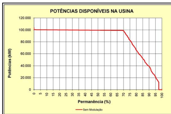
Figura 3-1 - Curva de Permanência e Potencia
