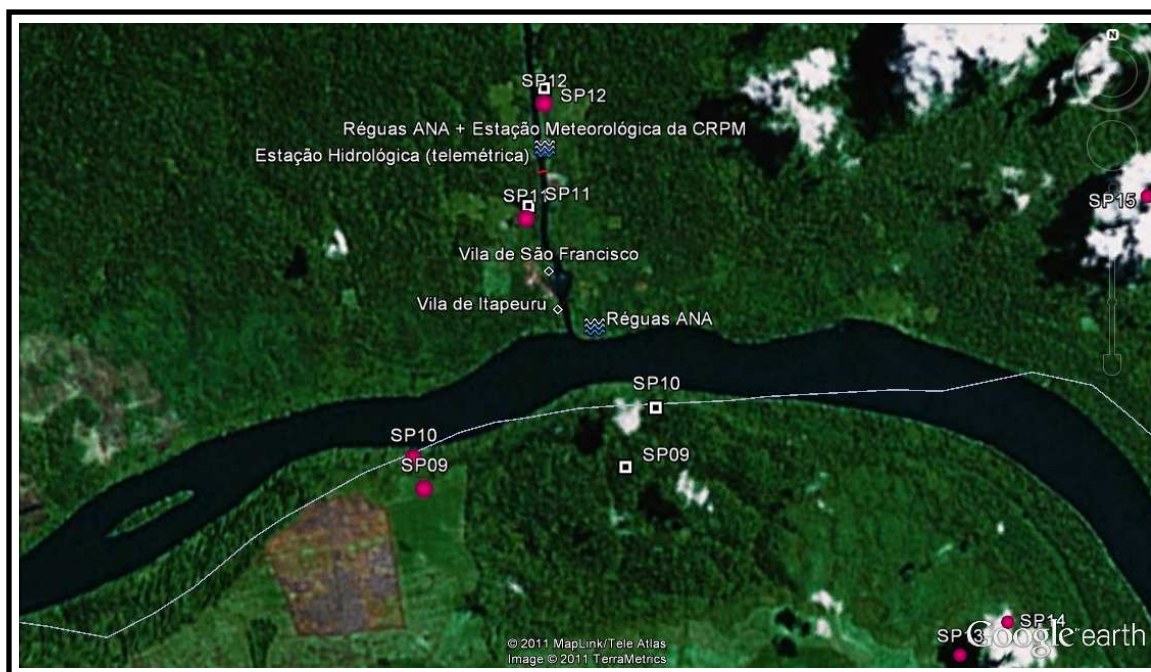
Figura 3 - Localização dos piezômetros SP09, SP10, SP11 e SP12. Os quadrados representam as posições teóricas dos piezômetros e as esferas rosas as posições identificadas em campo. O símbolo de ondas representam as posições das régua antiga da ANA e de uma estação meteorológica antiga da CPRM. Junto a régua antiga da ANA próxima ao SP12, será instalada uma estação telemétrica para medida da pluviosidade e do nível do Rio Iratapuru. A linha vermelha no Rio Iratapuru identifica a posição do perfil onde serão realizadas as medidas hidrossedimentológicas.
