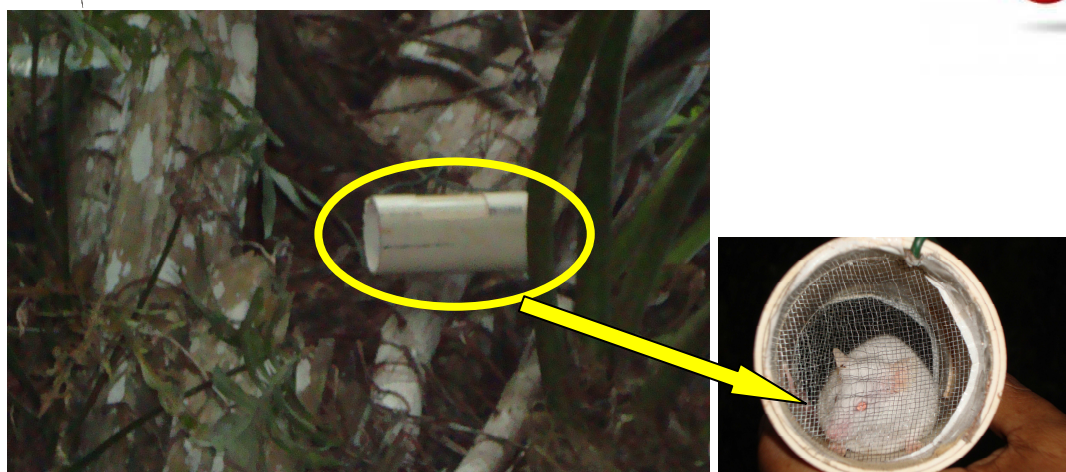
Figura 18. Armadilha de cola para triatomíneos com atração animal
