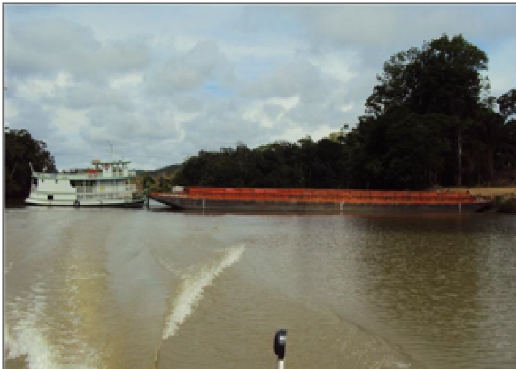
Foto 42 – Balsa para transporte de areia da draga até a obra.
