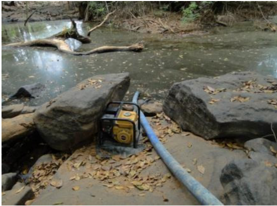
Uso de bombas de sucção para a drenagem dos poços.
