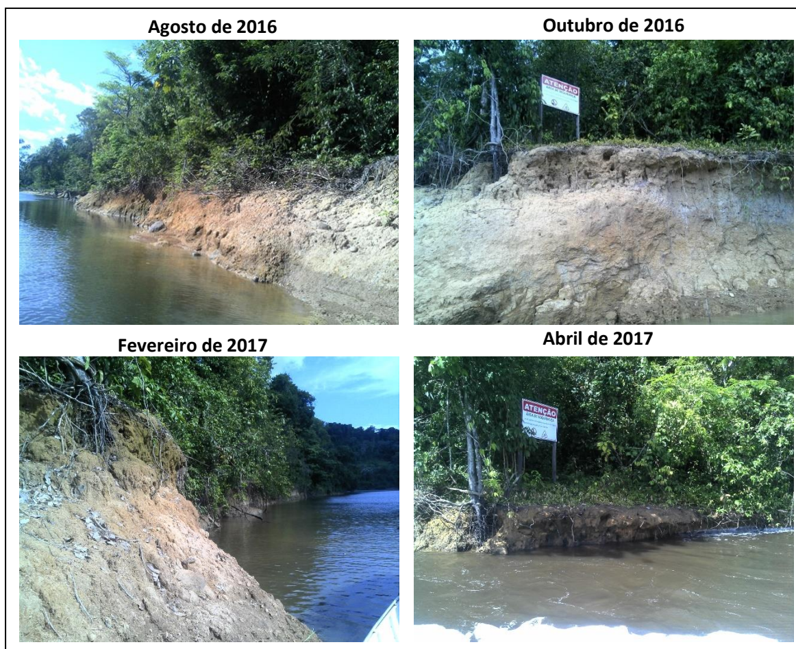
Figura 11. Ponto MJE-09 no Trecho erosivo do Canal Intermediário nas campanhas de agosto e outubro de 2016, e fevereiro e abril de 2017.
