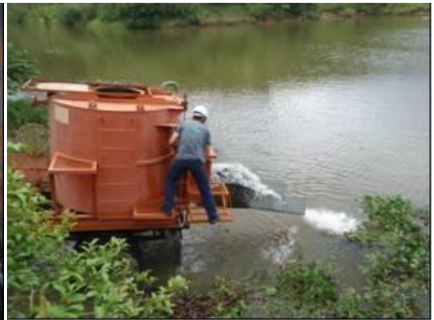
Figura 73– Detalhe da abertura da comporta do tanque.
