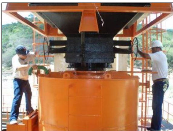
Figura 51 – Acoplamento da caçamba ao tanque.
