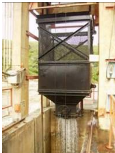
Figura 85 – Detalhe do encaixe da caçamba no tanque.
