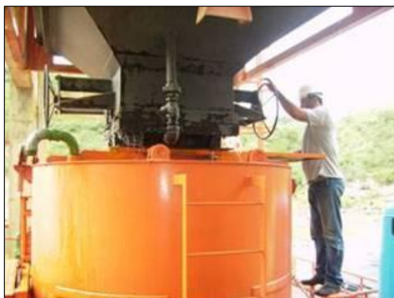
Figura 85 – Detalhe do encaixe da caçamba no tanque.
