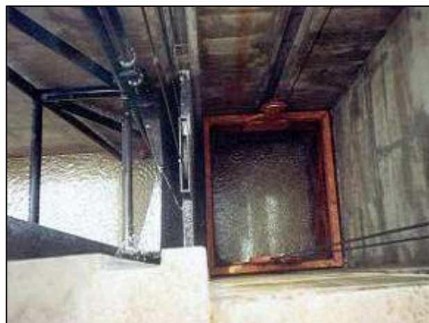
Foto 5 – Grade confinadora, grade móvel e caçamba.
