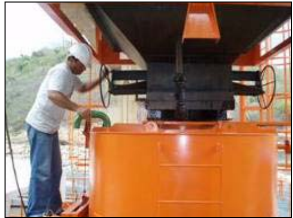
FOTO 5.4: ACOPLANDO A GAIOLA NO TANQUE.
