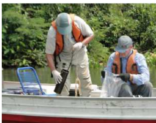
Foto 7.4.1.1.4.6/04 - Coleta de Sedimento - Acondicionamento de Amostra e Preparo de Draga para o Próximo Lançamento.
