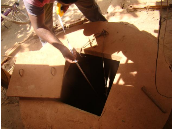
Foto 02/05 - Medição de profundidade e lâmina d'água na cacimba.
