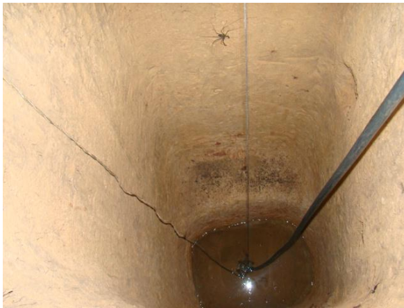
Foto 25/09 – Medição da profundidade e lâmina d'água da cacimba.
