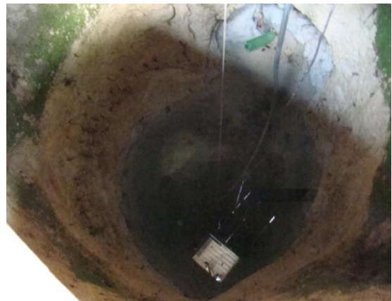
Foto 19/04 – Medição da profundidade e lâmina d'água.
