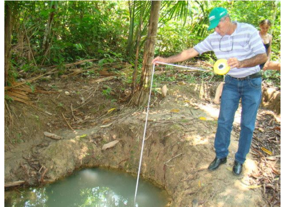
Foto 25/21 – Medição da profundidade e lâmina d'água da cacimba.
