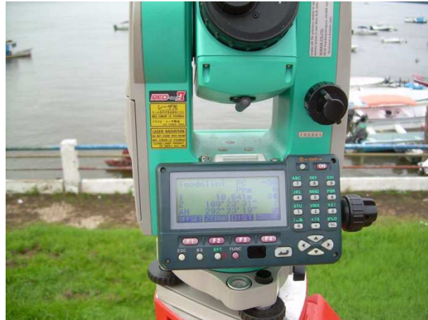
Estação Total em detalhe
