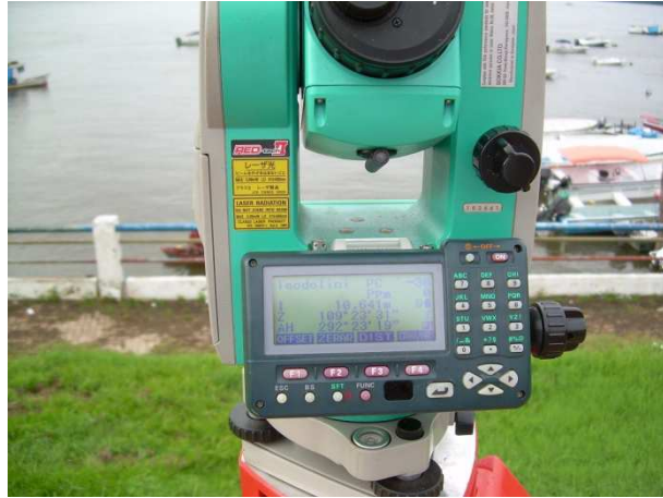
Estação Total em detalhe
