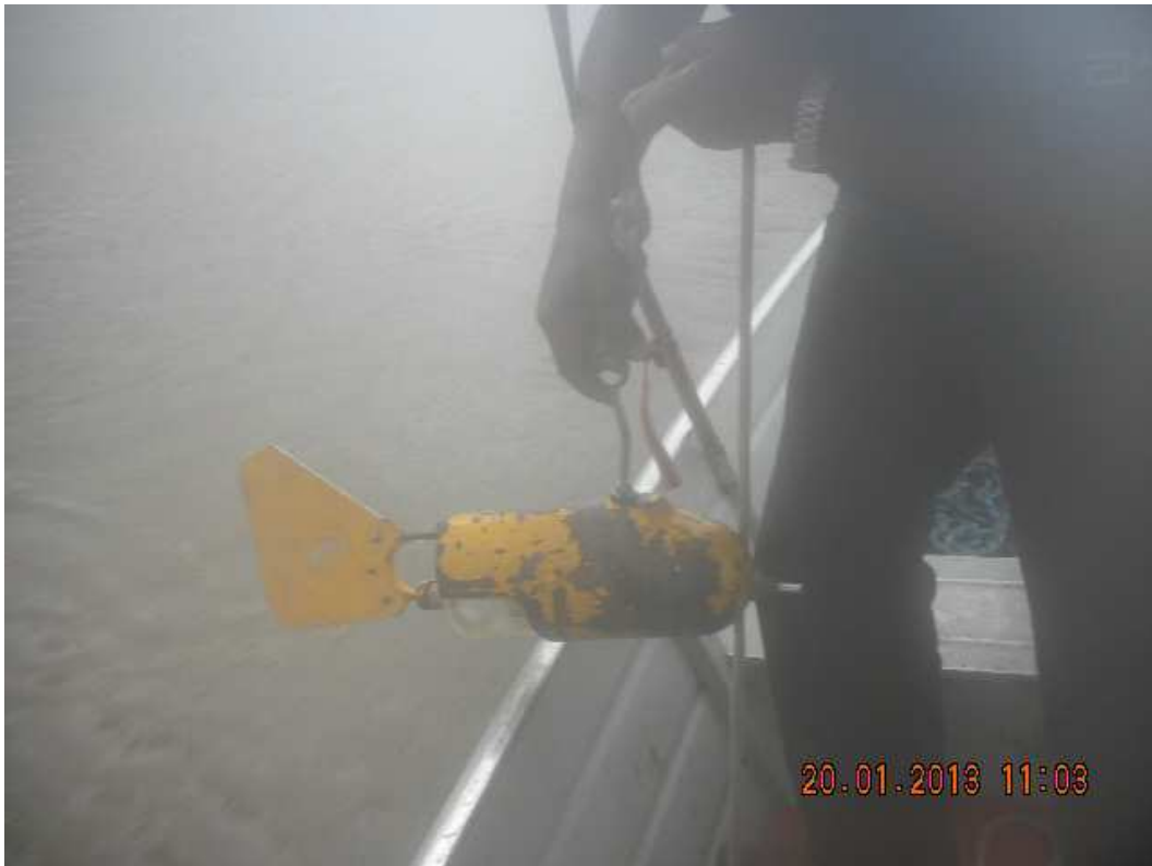
Rio Jamanxim em PR5 – amostrador com frasco para coleta de amostras – 20/jan/2013
