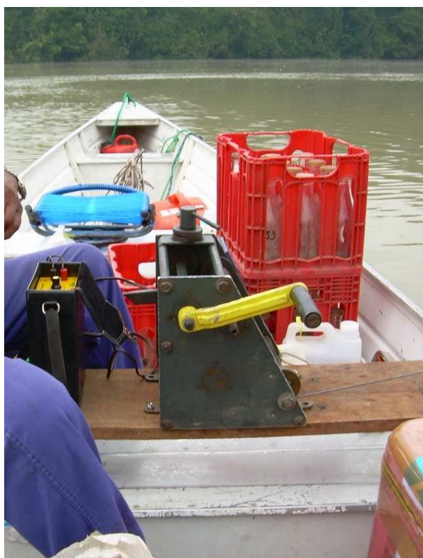
Rio Jamanxim em PR5 – medição de velocidades – 19/out/2012
