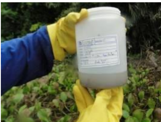
Foto 7.4.2.2.9.2/11 - Sedimento Coletado e Lavado para Análise em Laboratório - Acondicionado em Frasco Etiquetado.
