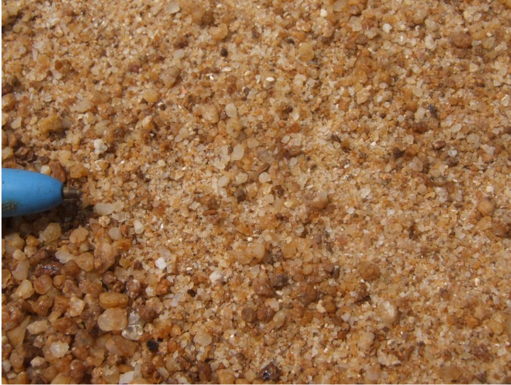
Foto 7.4.1.10/97 – Areia média e grossa com grãos subarredondados e angulosos que constituem as barras arenosas longitudinais (Coordenadas UTM 562025 x 9470977).
