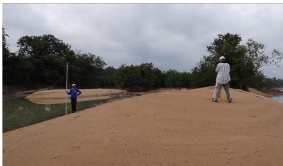
Foto 7.4.2.2.2.4.1/05 - Pesquisador mensurando a altimetria de uma praia com auxílio do nível topográfico.
