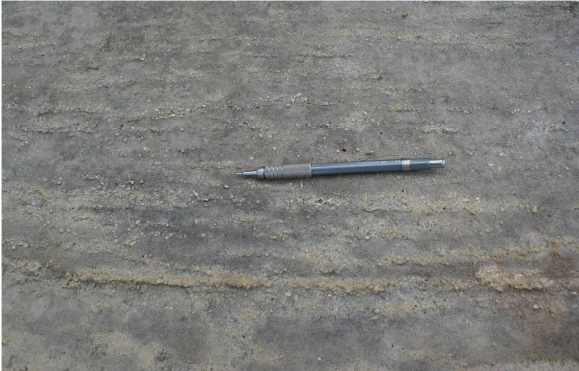
Foto 35 – Aspecto do arenito Maecuru, mostrando localmente grande variação granulométrica acompanhando os planos de estratificação.
