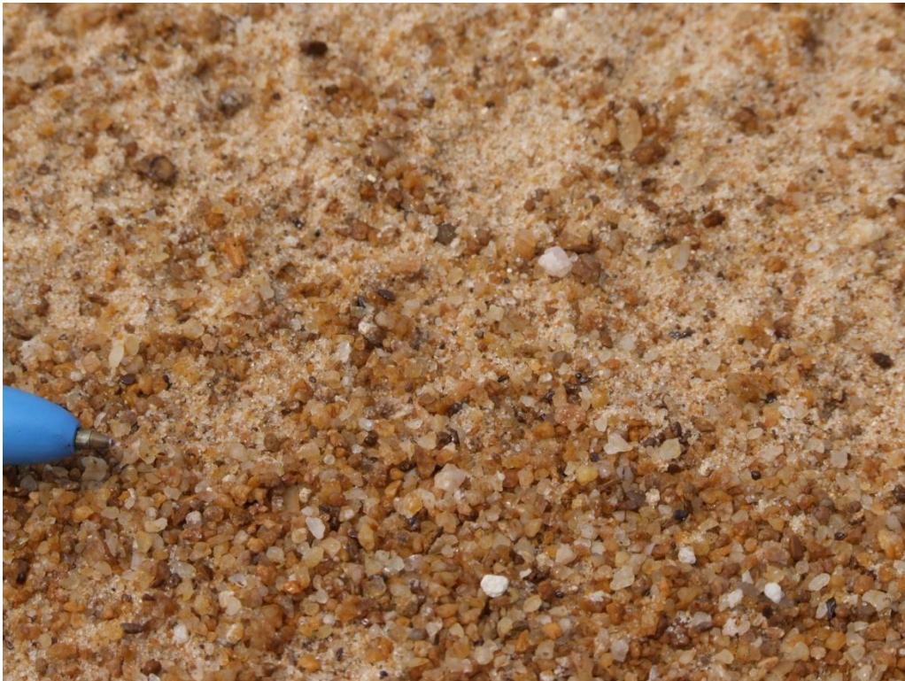
Foto 7.4.1.10/18 – Areia fina a muito fina e areia grossa com grânulos que constituem a barra arenosa longitudinal na praia da Planície de inundação da ilha de Itapucu (Coordenadas UTM 0601614 x 9516431).
