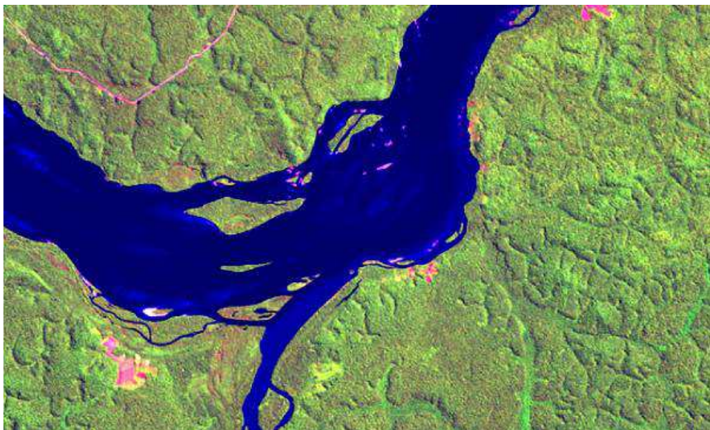
Figura 7.4.1.1.2.6.2.3.2/02 – Imagem de Satélite LANDSAT (2011) Mostrando Pluma de Material em Suspensão (azul clara) no Rio Jamanxim e na Margem Direita do Rio Tapajós. As Manchas Isoladas no Rio Tapajós Representam Depósitos de Areia Submersos.
