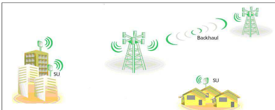
Figura 7.3.3.3.2.2/02- Diagrama básico de interconexão de um enlace geral envolvendo uma conexão Backhaul 41 e uma conexão ponto-multiponto.
