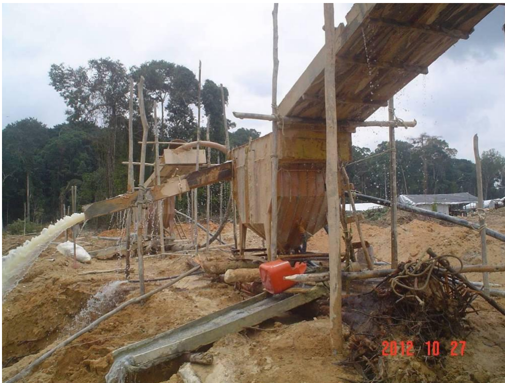
Foto 7.3.1.4.5.1/04 – Jigs concentradores em operação, no garimpo Chapéu de Sol, auxiliado por caixas concentradoras / bicas recuperando, também, o ouro (SIRGAS 2000/21M/535555/ 9463438).
