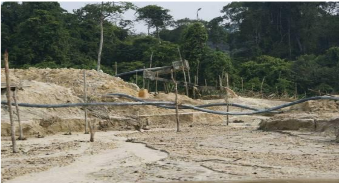
Foto 7.3.1.2.2.8.3.1/04 – Rio do Rato – Área explorada com PC. Notar mangueiras das “bombas” com captação diretamente no rio para lavagem do cascalho aurífero. Verificar que o material lavado e retornado diretamente para a calha principal (SIRGAS 2000/21M/511509/9399383).
