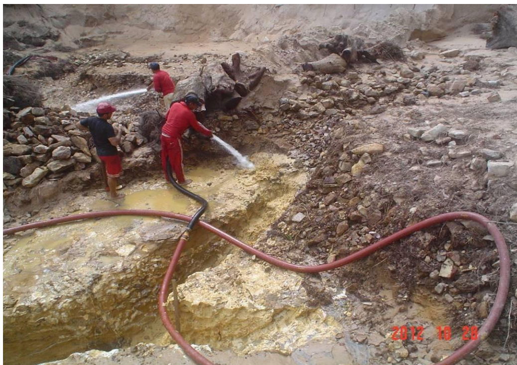
Foto 7.3.1.2.2.8.3.1/05 – Desmote hidráulico em garimpo de uma ilha do rio Jamanxim, próximo à cachoeira do Caí (SIRGAS 2000/21M/558594/9437678).
