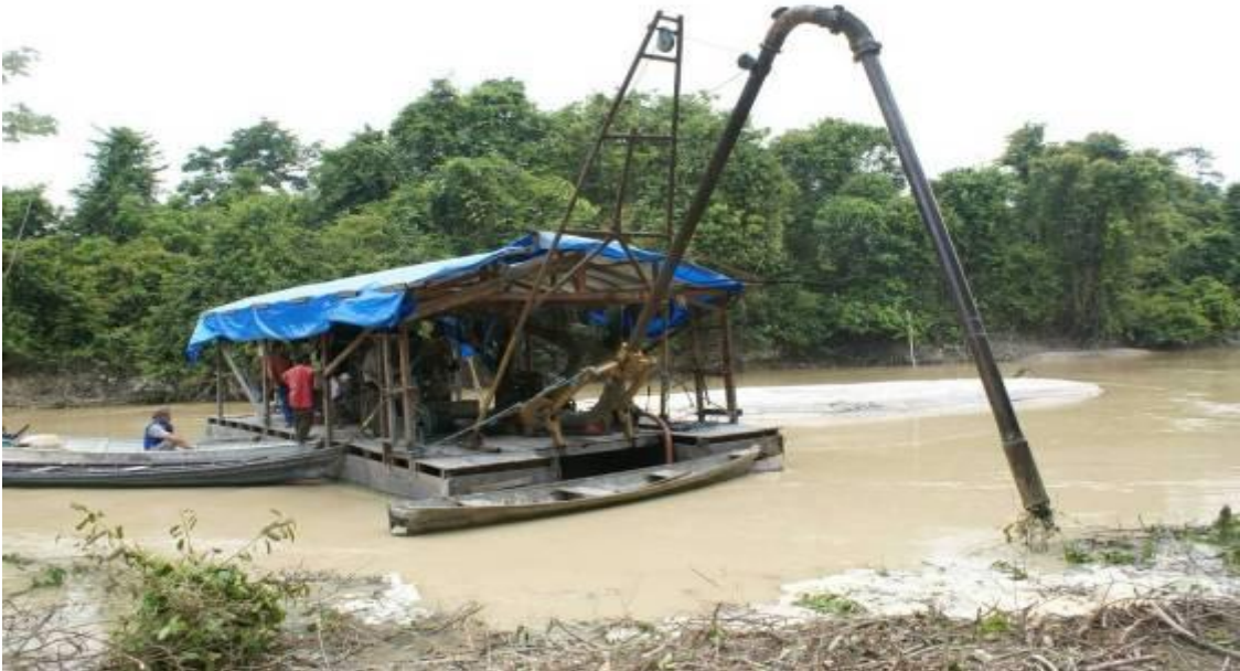
Foto 7.3.1.2.2.8.3.1/03 – Rio do Rato – Vista frontal da Balsa de Garimpo de ouro mostrando integralmente a lança de penetração (SIRGAS 2000/21M/ 515158/9395440).
