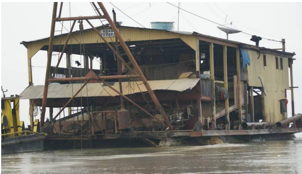
Foto 7.3.1.4.2.3/02 – Parte frontal de uma Draga “Escariante” (Draga Tubarão), instalada entre a localidade de Machado e a Boca do Rato, rio Tapajós (SIRGAS 2000/21M/521622/9415088).
