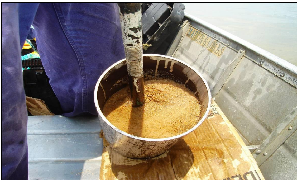
Foto 7.3.1.2.4.1.2/04 – Amostrador de material de fundo tipo Rock-Island .
