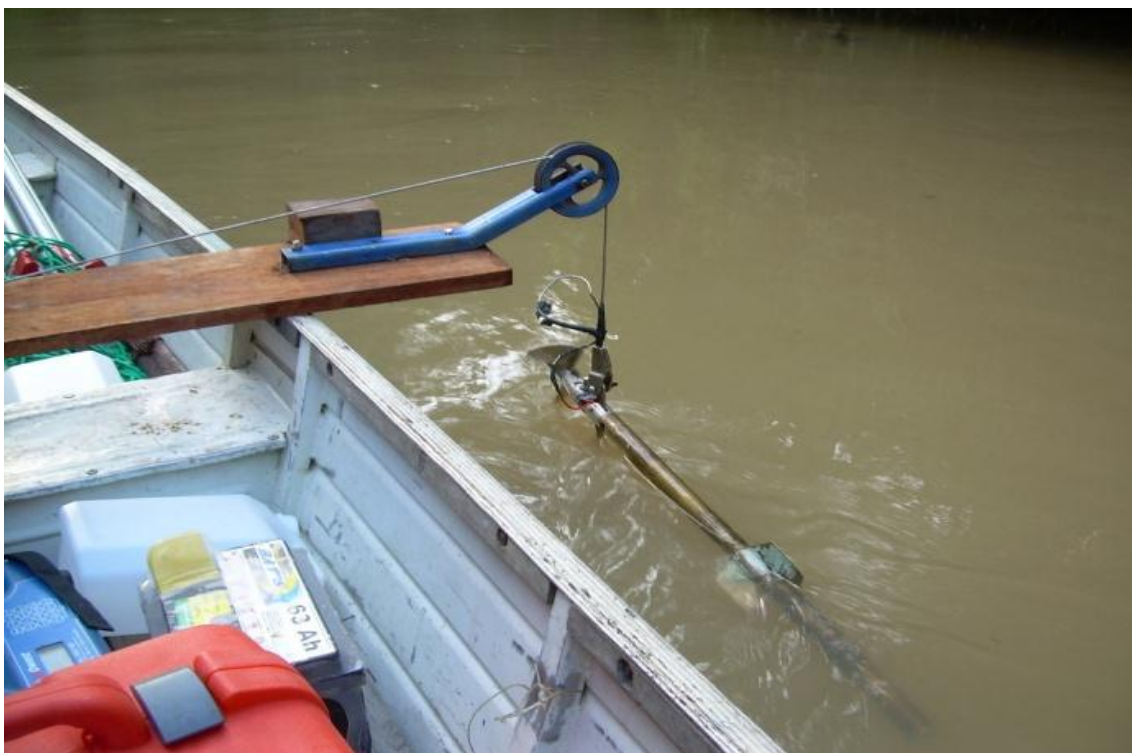
Foto 7.3.1.2.4.1.2/01 – Detalhe do Molinete Fluviométrico.
