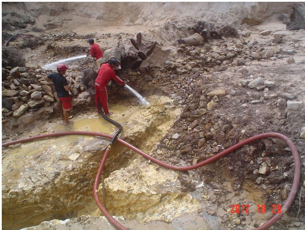
Foto 7.3.1.4.5.1/01 – Desmonte hidráulico em garimpo de uma ilha do rio Jamanxim, próximo à cachoeira do Caí (SIRGAS 2000/21M/558594/9437678).
