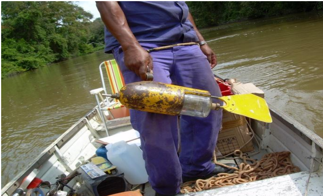
Foto 7.3.1.2.4.1.2/02 – Amostrador de sedimento em suspensão tipo DH-48.
