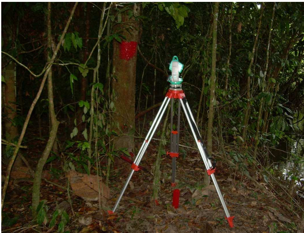
Rio Jamanxim em Jamanxim Montante – piquete com cota arbitrária – 100,00m e marco de segurança pintado na árvore com cota = 101,75m
