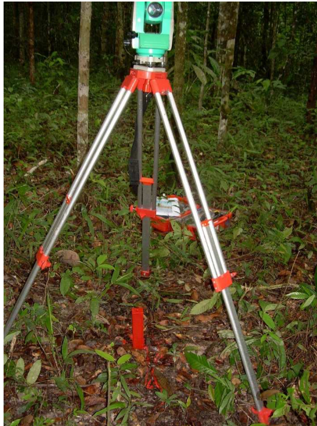
Rio Tapajós em CT7A - Piquete com cota arbitrária = 100,00m
