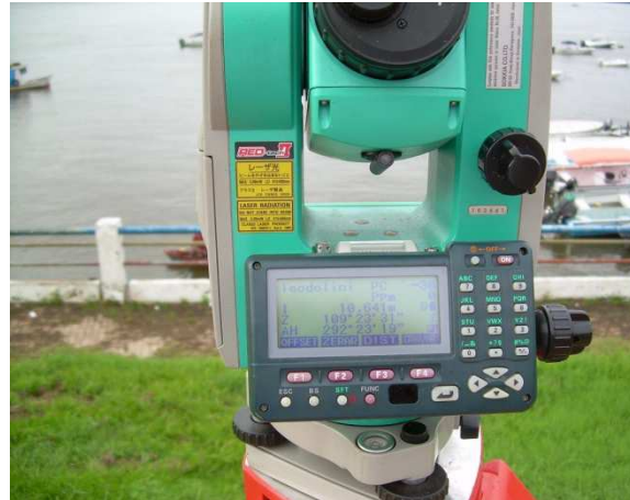
Estação Total em detalhe
