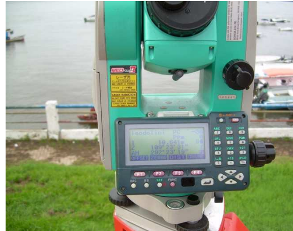
Estação Total em detalhe
