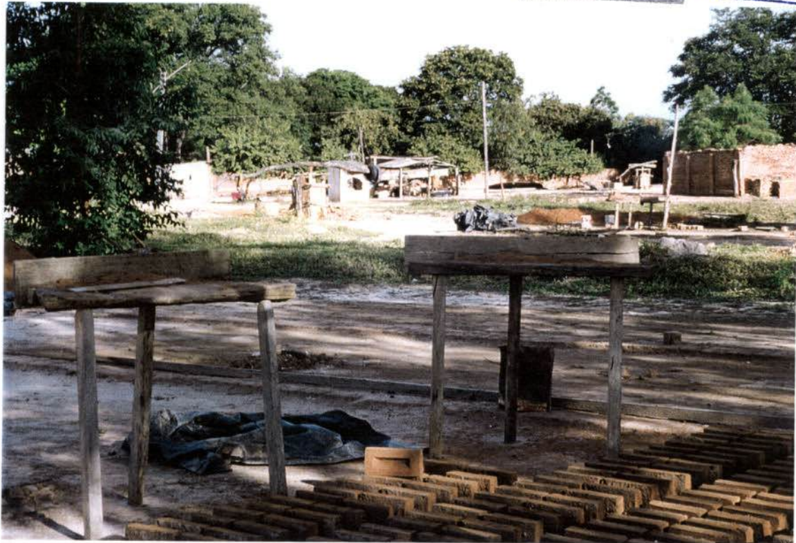
FOTO XVII - Bancadas de fabricação artesanal e exposição para secagem de tijolo - Três Lagoas/MS
