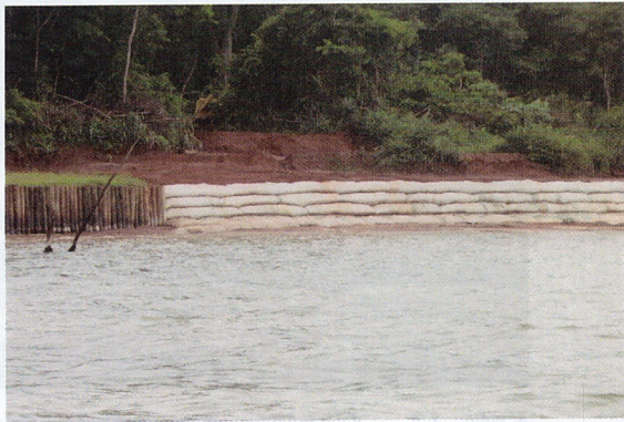
Foto 7 - Experimento com bolsacreto e paliçadas (S 22°22'32.0", W 52°58'11,13")
