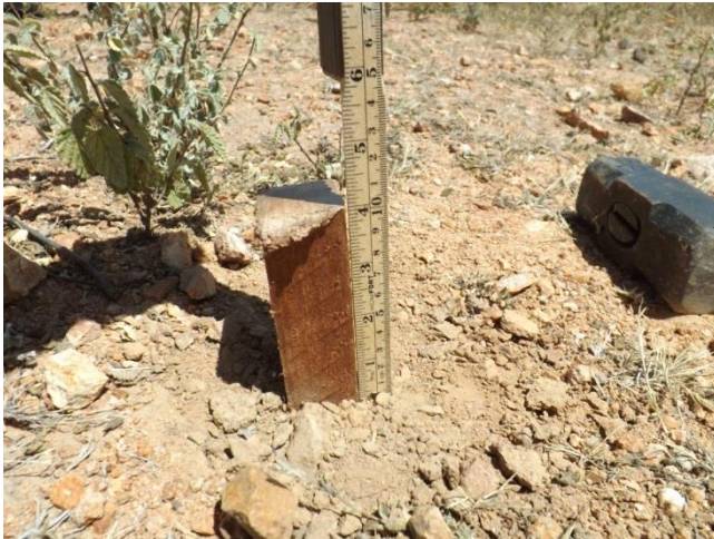
Foto 37. Estaca tipo pino cravado no interior da área, 10 cm visível na superfície do solo
