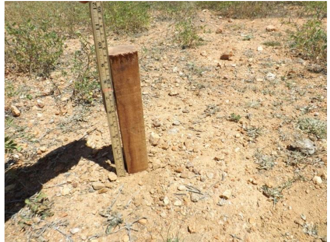
Foto 38. Estaca cravada em um dos vértices do perímetro
