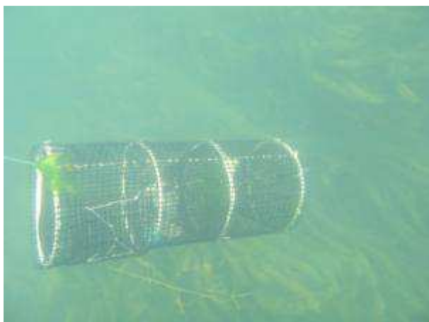
Foto 5-3: Covo utilizado durante o monitoramento da carcinofauna, em momento de seu recolhimento. Observar na parte central do covo a isca protegida e a densa concentração de macrófitas
