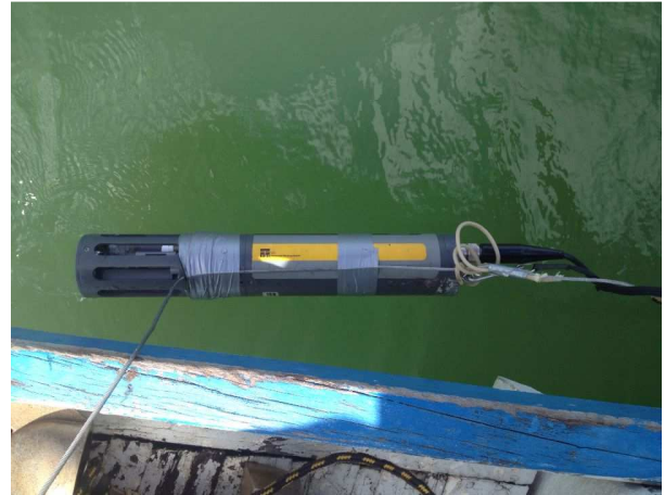
Foto 9-2: Sonda multiparamétrica para amostragem da salinidade e temperatura da água.
