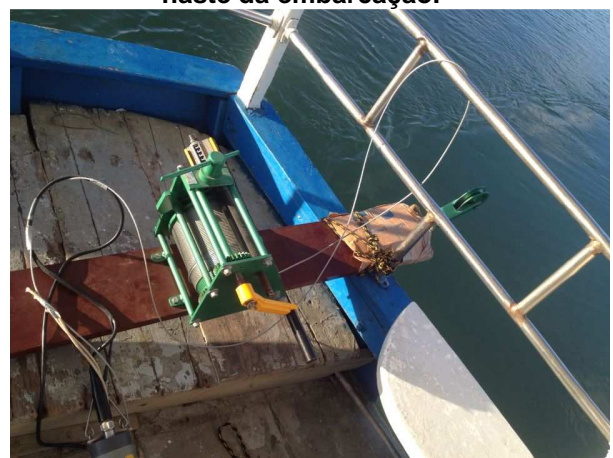
Foto 9-10: Guincho manual utilizado para descer a sonda multiparamétrica.
