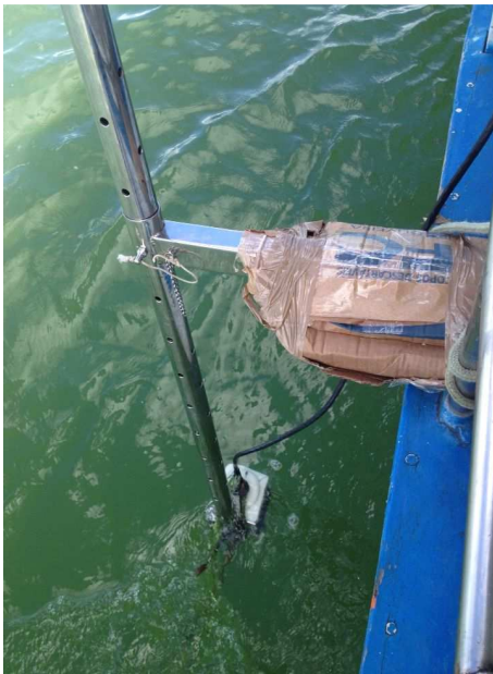
Foto 9-5: ADCP utilizado para medição da velocidade e direção da corrente.
