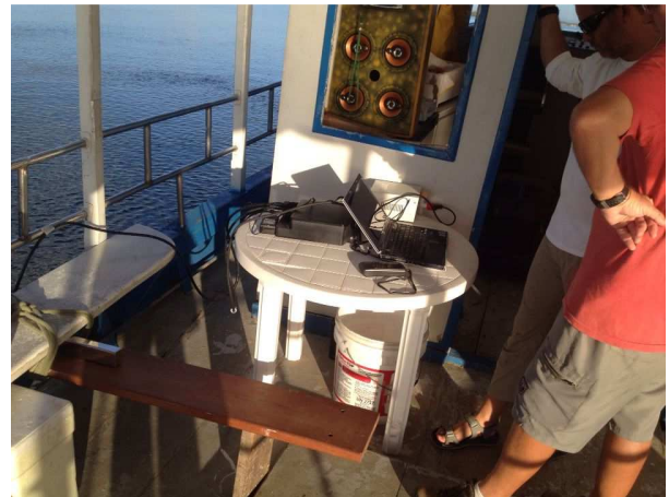
Foto 9-6: Disposição do decodificador e computador acoplados ao ADCP.
