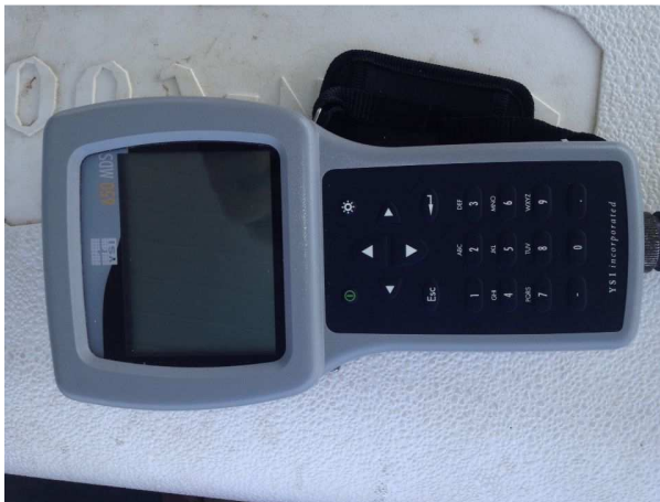
Foto 9-3: Display YSI acoplado a sonda multiparamétrica.
