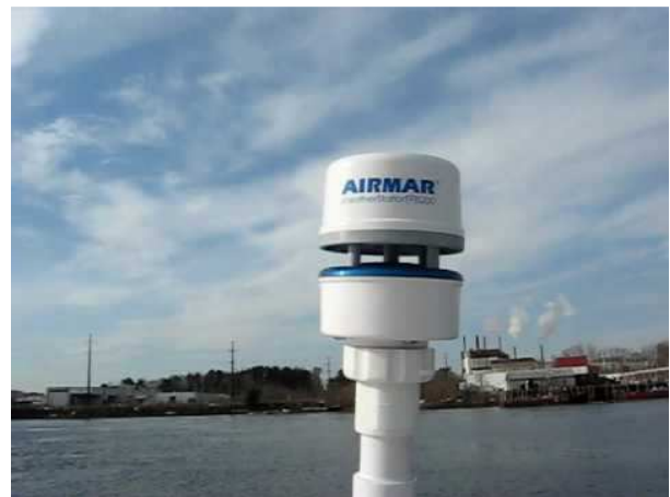
Foto 9-8: Estação meteorológica fixada na haste da embarcação.
