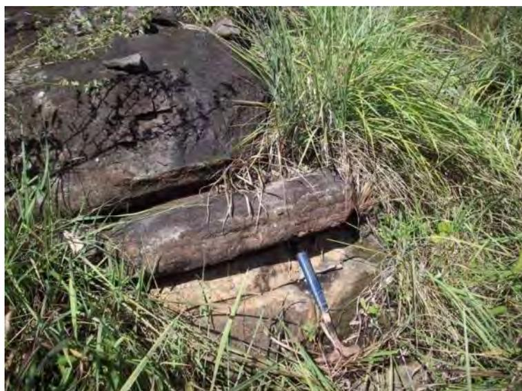
**Ilustração 6-38. Junta de alívio em rocha próximo a futura ombreira direita (Ponto 16).**
