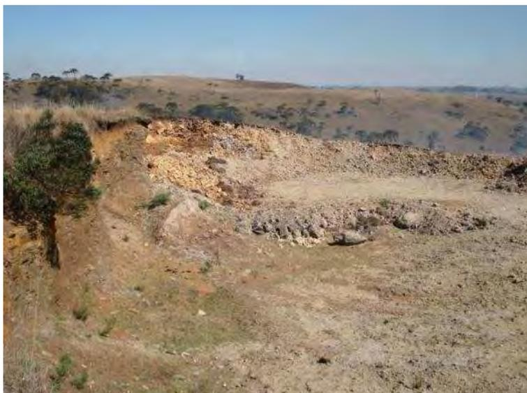
**Ilustração 6-46. Saibreira onde o material não intemperizado é desprezado (Ponto 66).**
