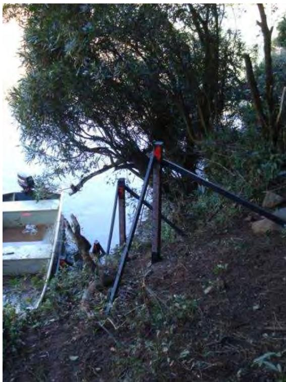
Ilustração 6-141. Lance de réguas linimétricas na seção de medição.
