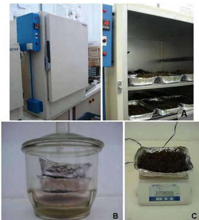
Ilustração 6-779. Processamento das amostras em laboratório para determinação da biomassa total das macrófitas: a) secagem em estufa; b) amostras no dessecador após secagem; c) pesagem em balança de precisão.
