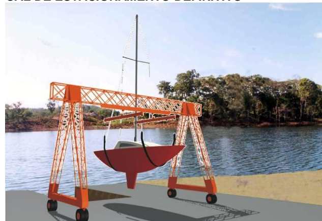
FIGURA 101 – IÇAMENTO DO BARCO, ATRAVÉS DE PÓRTICO, ATÉ À CARRETA QUE O LEVARÁ AO LOCAL DE ESTACIONAMENTO DEFINITIVO
