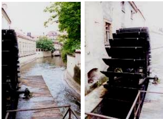
FIGURA 1 – RODA RASTEIRA DO SÉCULO XIX, CONSTRUÍDA NO RIO VITAVA EM PRAGA, REPÚBLICA TCHECA
