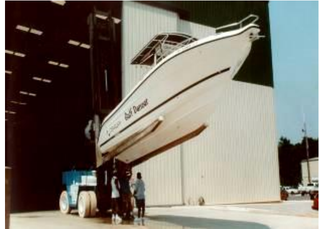
FIGURA 43: E BARCO SENDO RETIRADO DO "DRYSTACK" PELO "FORKLIFT"
