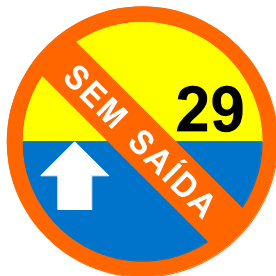
FIGURA 35: P03-E- PLACA IDENTIFICADORA DE SAÍDA INTERROMPIDA NA MARGEM ESQUERDA
