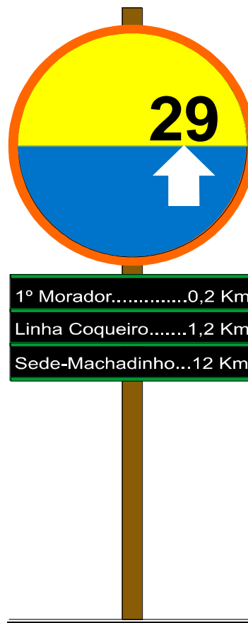
FIGURA 43: VISTA DO MODELO EXEMPLIFICATIVO COM PLACA DE SAÍDA DE EMERGÊNCIA À DIREITA ACOMPANHADA DE TRÊS COMPLEMENTARES
