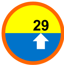
FIGURA 34: P02-D- PLACA IDENTIFICADORA DE SAÍDA DE EMERGÊNCIA À DIREITA
