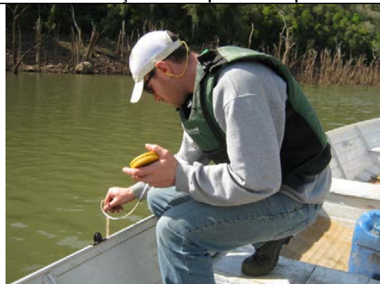
Foto 05: Medição de transparência no ponto 17.
