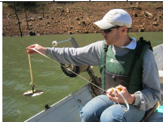
Foto 03: Medição de transparência no ponto 15.
