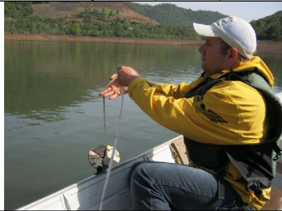
Foto 07: Medição de transparência no ponto 22.
