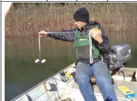
Foto 13: Medição de transparência no ponto 23.
