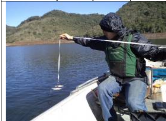
Foto 11: Medição de transparência no ponto 22.
