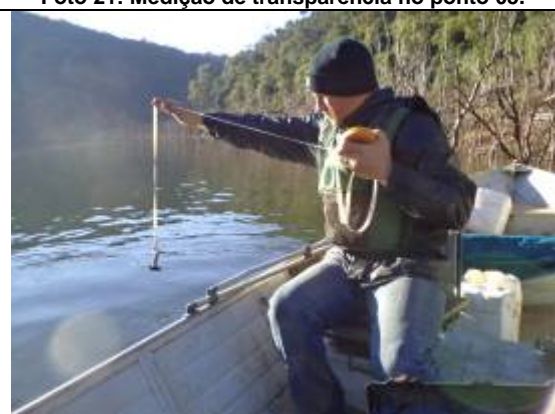
Foto 23: Medição de transparência no ponto 31.
