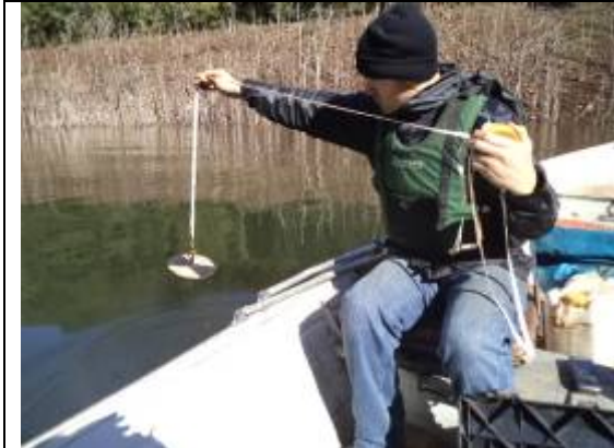
Foto 09: Medição de transparência no ponto 21.
