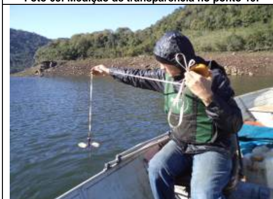
Foto 07: Medição de transparência no ponto 20.
