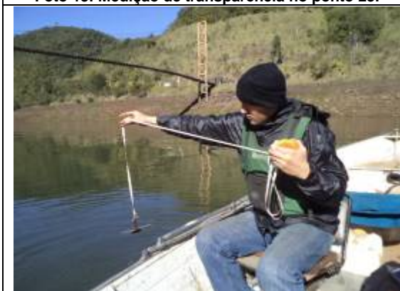
Foto 15: Medição de transparência no ponto 25.
