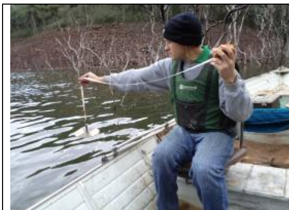
Foto 01: Medição de transparência no ponto 14.
