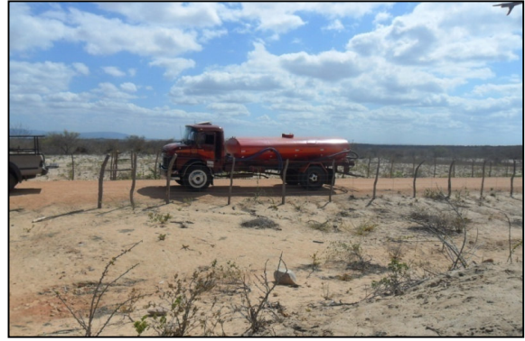
Foto 6 – Caminhão Pipa para abastecimento dos reservatórios (PETCON, 2013).
