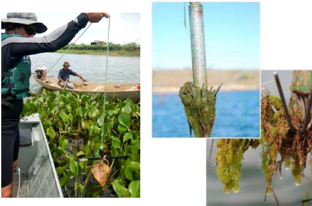
Figura 7-3: Garatêia adaptada para coleta de macrófitas submersas.
