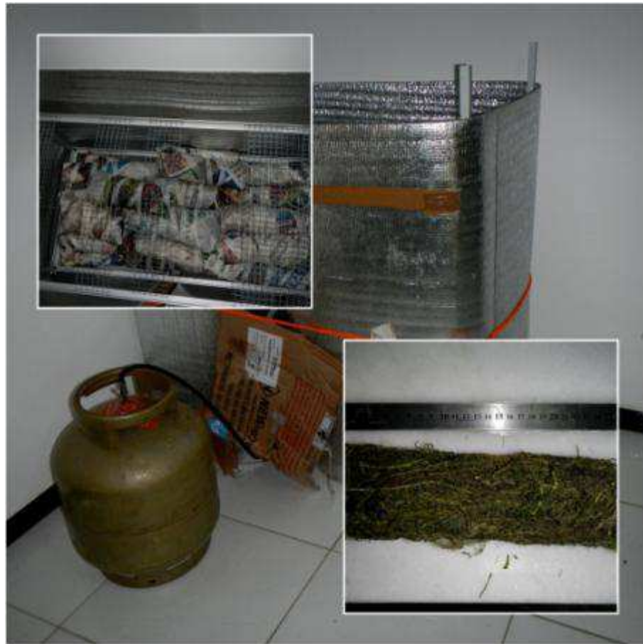
Figura 7-13: Estufa de secagem a gás, em detalhe, frações de macrófitas embaladas em jornais e separadas por espécies.
